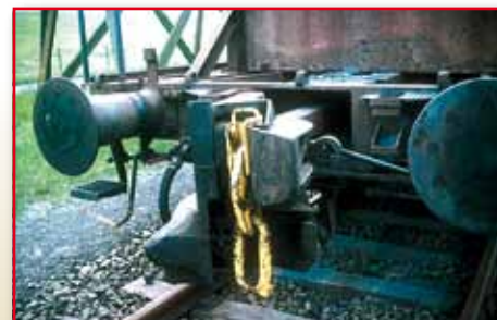
Detail-Aufnahme der AK 69 - Automatik-Kupplung für Erzwagen.
