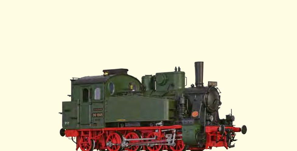
Modell: Ausführung mit Tonnendach; 3 Dome; Oberflächenvorwärmer; elektrische Beleuchtung
