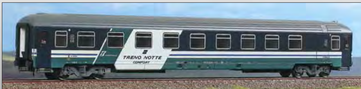
Carrozza UIC-X cuccette Comfort "Treno Notte" Trenitalia per il servizio interno. Couchette car Type UIC-X "Treno Notte Comfort" of Trenitalia for internal service. Liegewagen Typ UIC-X 1970 "Treno Notte Comfort" der Trenitalia
