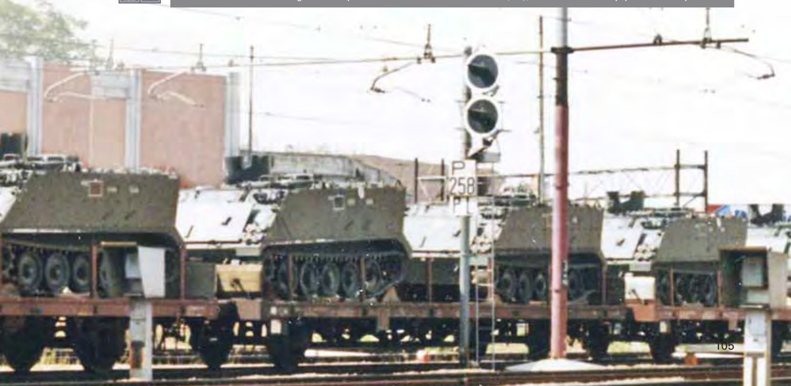
Set di due carri FS Rlmpmp-t caricati con carri armati Leopard della Brigata Corazzata Ariete. Set of two Italian special flat car loaded with Leopard tank of "Brigata Corazzata Ariete" Zwei Schwerlast-Flachwagen Rlmpmp-t der Italienischen Staatsbahn (FS), beladen mit Kampfpanzern Leopard.
