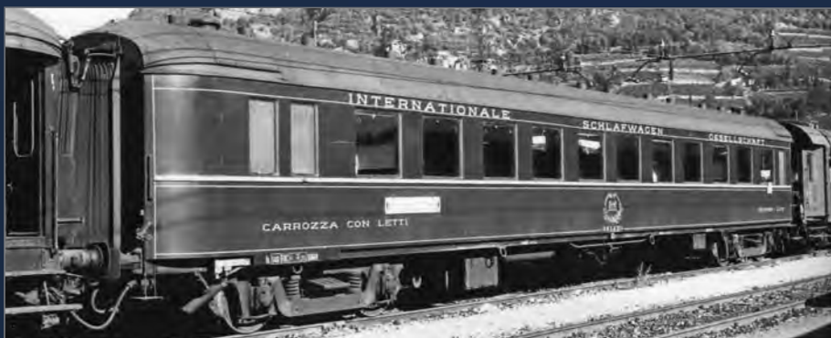
Carrozza letti Tipo Ub, in livrea e carrelli originali CIWL, di costruzione GANZ. Original epoche IV CIWL sleeping car with PP bogies built by GANZ. Ursprünglichen ISG Schlafwagen mit PP Drehgestellen von GANZ gebaut.
