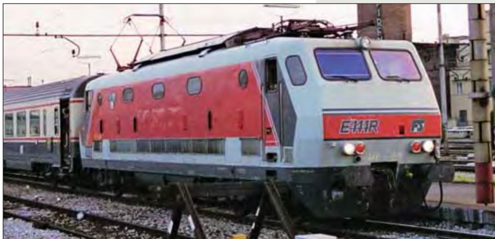
Locomotiva elettrica FS E.444R stato attuale, con conduttori a 13 poli per il comando lateralizzato delle porte del treno. Electric Locomotive FS E.444R in today's conditions, with 13-pin cable for independent side control of the train doors. E-Lok E.444R der FS in derzeitiger Version, mit 13-Pol-Kabel für die seitenabhängige Steuerung der Zugtüren
