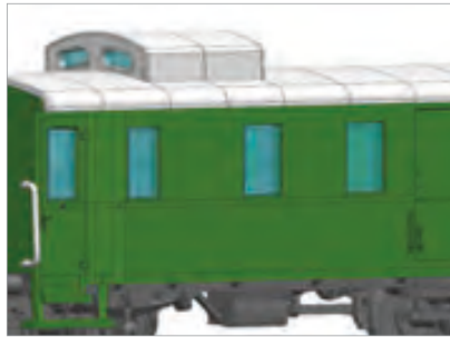
■ Dach mit Kanzel
