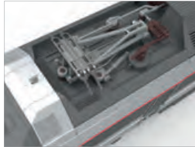
■ Filigrane Dachleitungen und Pantografen
