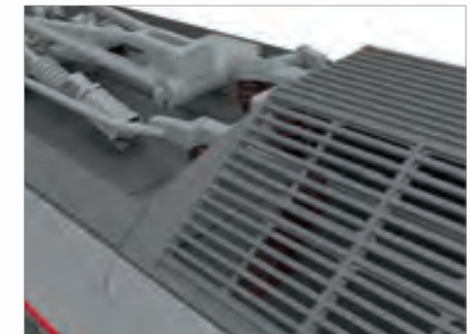
■ Durchbrochen dargestellter Dachaufbau aus Ätzblech
