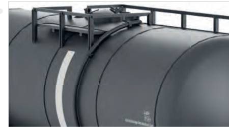
Extra angesetzte Leitung für Chemiekessel
