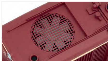
Abdeckung über dem separat angesetzten Lüfterrad als zierliches Ätzteil umgesetzt
