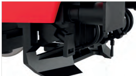
Schienenräumer am Chassis montiert
