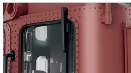
Scheibenwischer in alter Bauform ausgeführt
