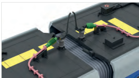
Mehrteilige und farblich abgesetzte Dachausrüstung
