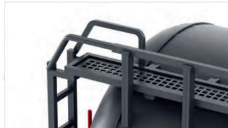
Durchbrochen dargestellte Laufgitter aus Ätzblech
