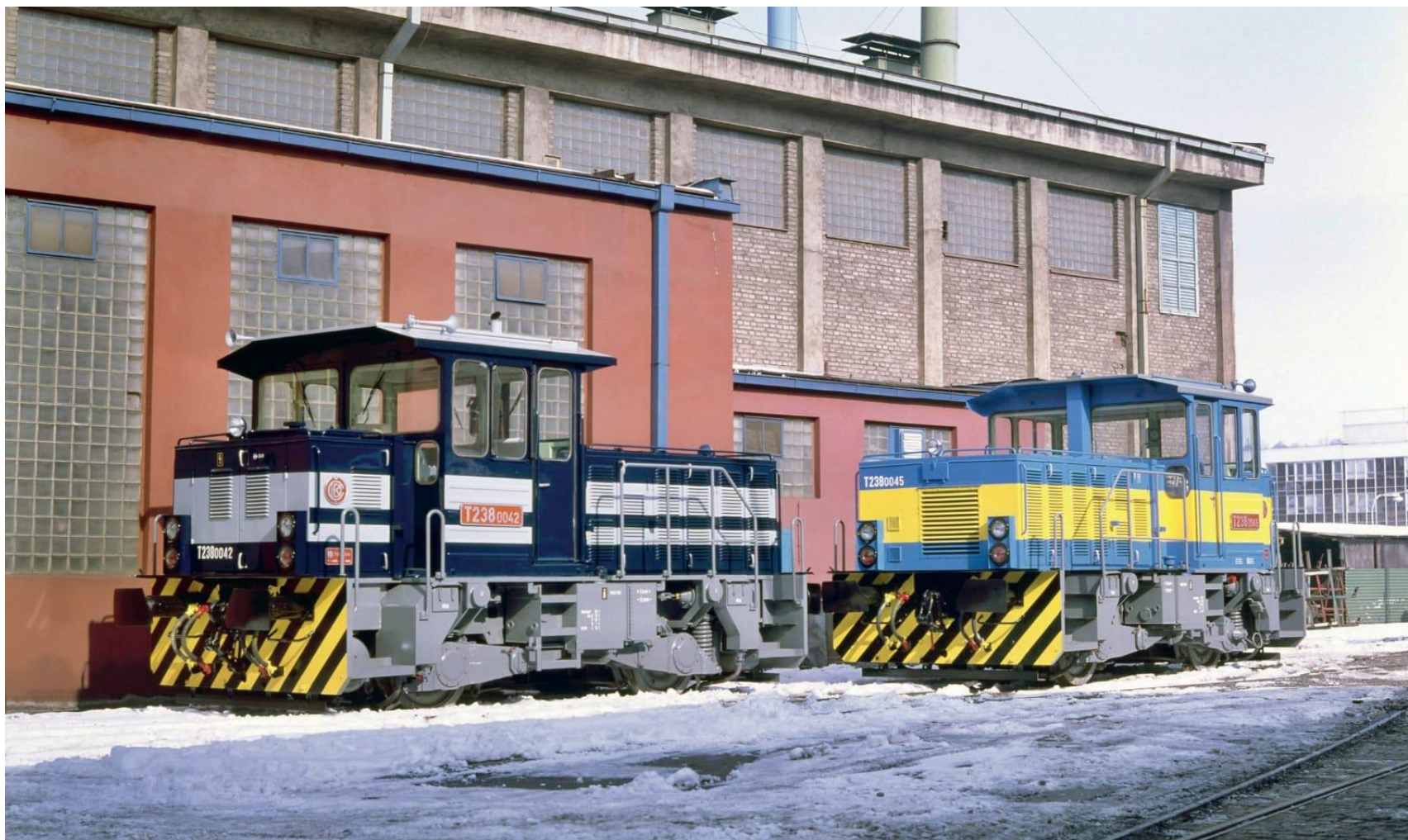
Výrobní program ČKD se na počátku 90. let minulého století zaměřoval mimo jiné na posunovací lokomotivy. Mimo čtyřnápravových lokomotiv řad 729 a 731 to byly dvounápravové lokomotivy řad T 238,0 a T 239,1 pro československý průmysl a řady 704 pro státní dráhu. Na konci roku 1993 se ve výrobním závodě setkaly stroje T 238.0042 pro Škodu Plzeň a 0045 pro Solo Sušice. (foto: Ing. Bohumil Skála)
