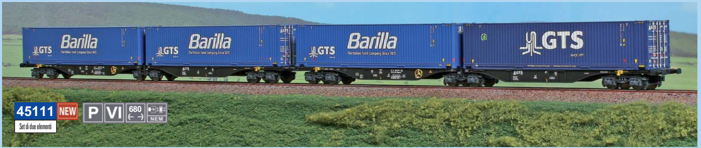
"Il treno della pasta". Set di due carri bi-modulo da 90 piedi GTS con casse mobili "Barilla" e "GTS". "Pasta train". Set of two container wagons Type Sggmrss '90 GTS with "Barilla" and "GTS" containers. "Der Nudel-zug". Set aus zwei 90-Fuß-GTS-Bimodul-Wagen mit Barilla- und GTS-Wechselpritschen.
