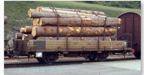
2263 110 Kk-w 7340 mit Klappbrücke für Holztransport
