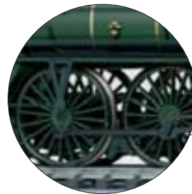
Riesige Treibräder – Durchmesser im Original: 2,20 m
