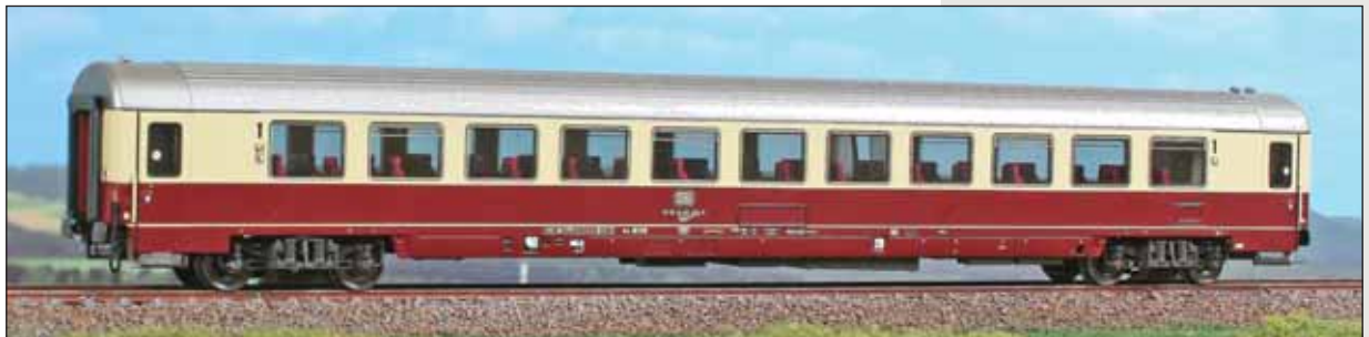
Carrozza DB Tipo Apmz 123 di 1ª classe nella livrea rosso e crema. DB Type Apmz 123 1 st class car, red and cream livery. DB Typ Apmz 123 1. Klasse Wagen, rot/beiger Lackierung.
