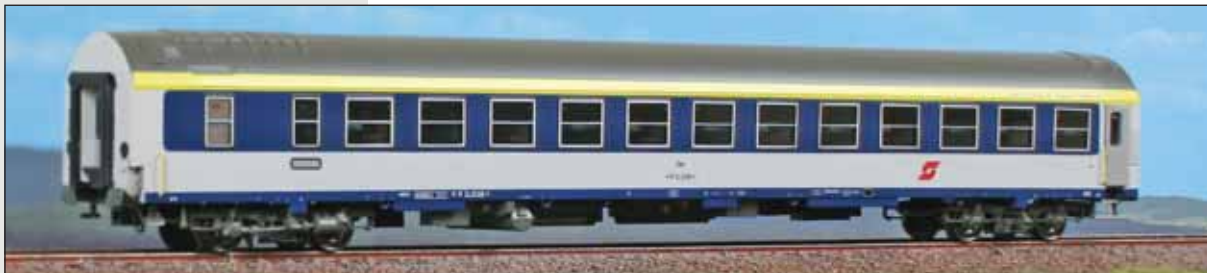
Carrozza letti FS Tipo MUs (1967) ex 4802, ricostruita con aria condizionata, in livrea bicolore delle ÖBB. Type MUs (1967) ex 4802 sleeping car, rebuilt with air condition, in two color livery of the ÖBB. Typ MUs (1967) Schlafwagen ex Nummer 4802, mit Klimaanlage rekonstruiert, in zweifarbigem Lackierung der ÖBB.
