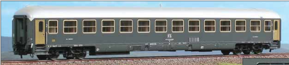
Carrozza di 2ª classe Tipo UIC-X 1970 con carenature originali grandi ed impianto condizionamento Friedmann-Luwa, in livrea grigio ardesia, epoca IV.
