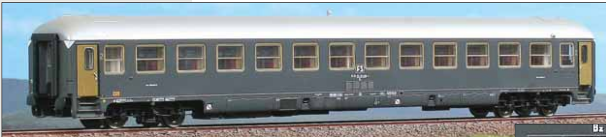
Carrozza di 2ª classe Tipo UIC-X 1970 con carenature originali grandi ed impianto condizionamento BBC, in livrea grigio ardesia, epoca IV.
