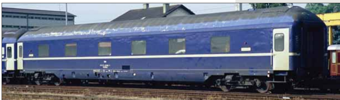
Carrozza letti WLABmz con carrelli München-Kassel, livrea blu con fasce e porte bianche. Sleeping car WLABmz with München-Kassel bogies, blu livery with white stripe on sides and white doors. Schlafwagen WLABmz mit München-Kassel-Drehgestellen, blaue Livree mit weißen Bändern und Türen.
