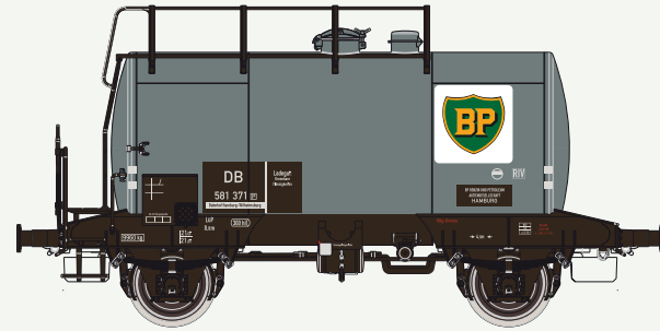
36222 , Kesselwagen, Deutz, BP 581 371, grau, DB, Ep III, DC
