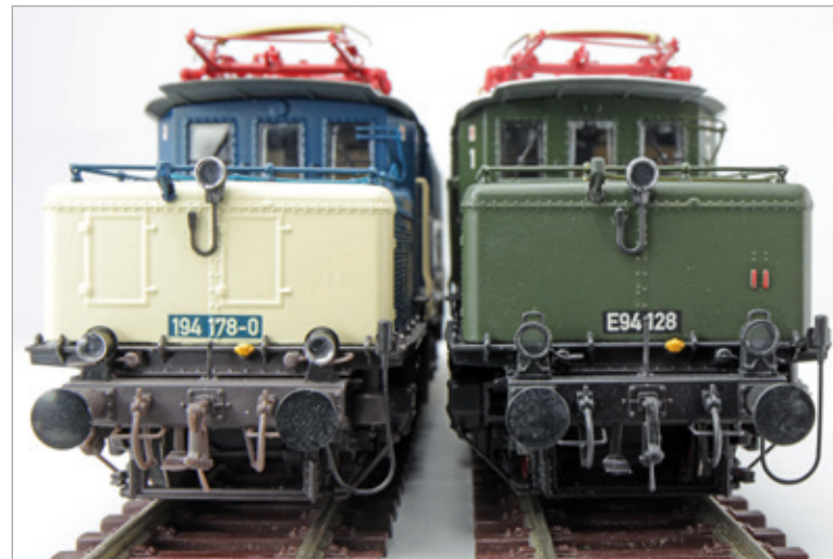
Unterschiedliche Vorbauten von Serien- und Nachbaulok
