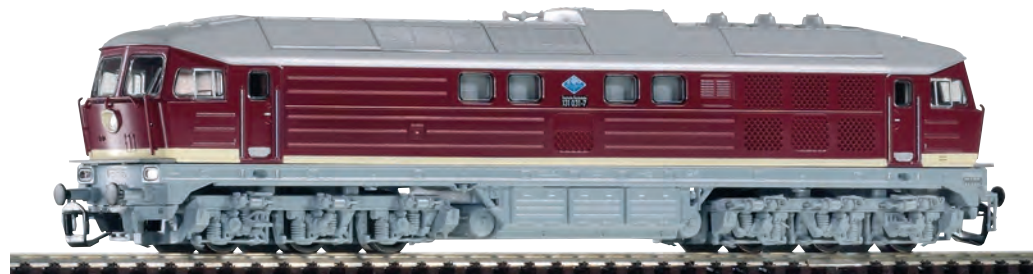
47326 Diesellokomotive BR 131 DR Ep. IV mit neuer Dachausrüstung mit geänderten Lüftern
